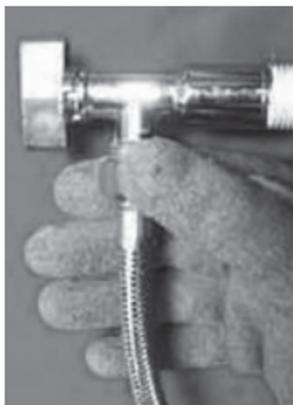
2. SÓLO EN EL EXTREMO DE ACOPLA DE LA TUERCA DE 1/2" DAR MÁXIMO MEDIA VUELTA ADICIONAL A LA ROSCA CON UNA HERRAMIENTA.
